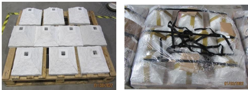
Figure 46 : La phase de fixation par 10 ailettes sur palette et la phase d'emballage.
