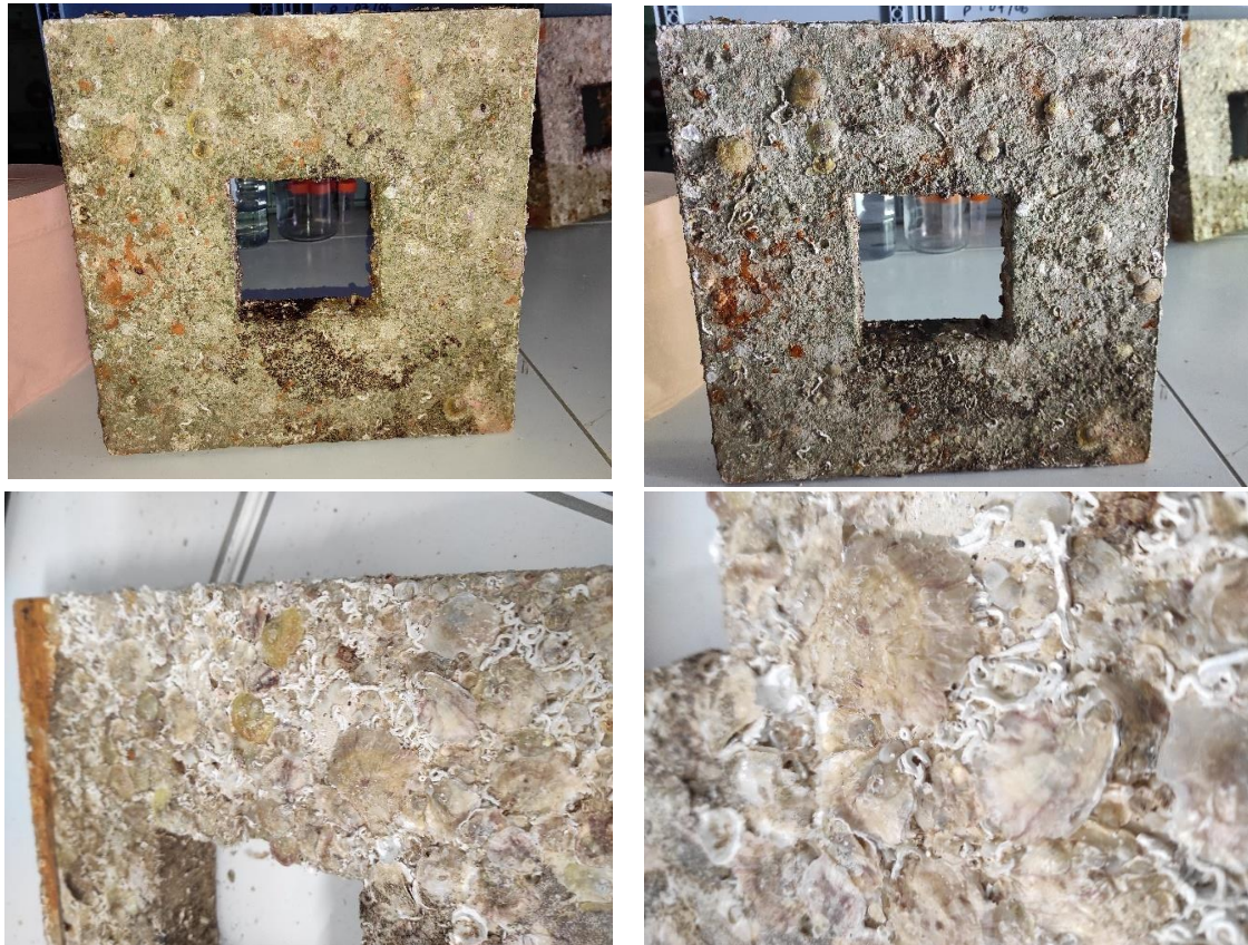
Figure 43 : Colonisation des ailettes après immersion de 2 mois en Bretagne.
